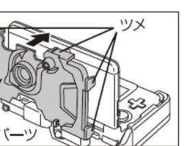
ニンテンドー3DSのふたを開じてから本体を裏返し、爆ツリールの凸部を凹部にスライドさせて、カチッと音がするまでめ込みます。
