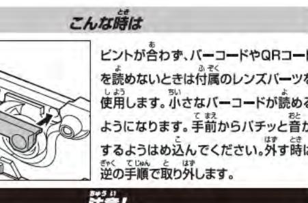
ピントが合わず、バーコードやQRコードを読み取れないときは付属のレンズパーツを使用します。小さなバーコードが読めるようになります。手前からバチッと音がするよう込め込んでください。外す時は逆の手順で取り外します。
